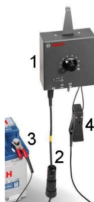
Rys.12 Moduł BDM298 (1) firmy Bosch do pomiaru prędkości obrotowej czterosuwowych silników spalinyowych, na podstawie tętnienia napięcia w instalacji elektrycznej samochodu. Opis w tekście artykułu. (Źródło: Robert Bosch)
