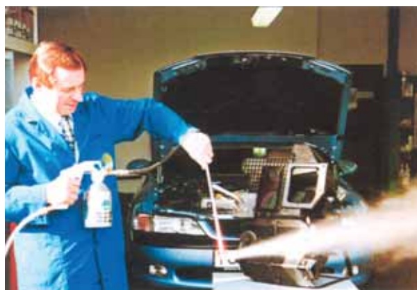
Fot.4 Do nanoszenia środka czyszczącego na parownik, najlepiej jest używać urządzenia natryskowego zasilanego sprężonym powietrzem. Przeważnie wykorzystywana jest sonda natryskująca strumień prostopadle do osi sondy. (Źródło: Tunap).
