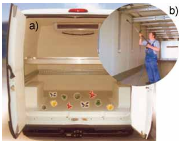
Fot.19 W chłodzonych ładowniach samochodów dostawczych ciężarowych oraz nacze, wraz z upływem czasu rozwijają mikroorganizmy (a), takie same jak na powierzchni parownika. Z pomocą środka czyszczącego trzeba je okresowo usuwać (b). (Źródło: Tunap)
