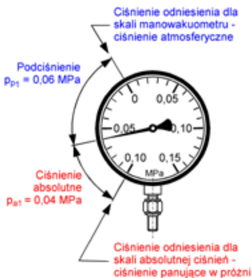
Rys.3 Na skali manowakuometru są zaznaczone: wartość ciśnienia absolutnego p_{a1} i odpowiadająca mu wartość podciśnienia p_{p1} . Te same wartości ciśnień są zaznaczone na rys.1.
