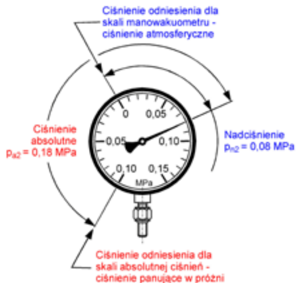
Rys.4 Na skali manowakuometru są zaznaczone: wartość ciśnienia absolutnego p_{a2} i odpowiadająca mu wartość nadciśnienia p_{n2} . Te same wartości ciśnień są zaznaczone na rys.1.
